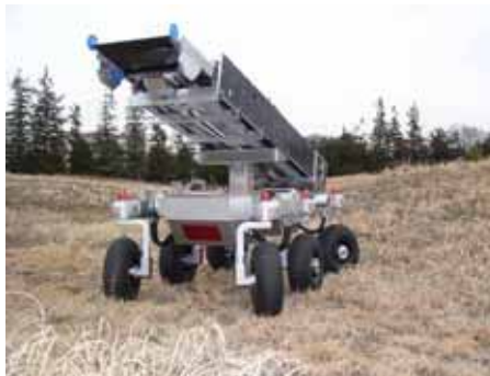
図2 今回開発した親ロボット（伸展式の梯子の上に子ロボットを2台搭載する）
