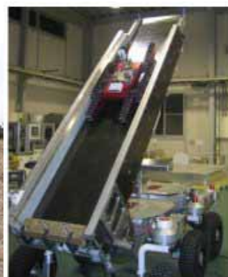
図2 今回開発した親ロボット（伸展式の梯子の上に子ロボットを2台搭載する）
