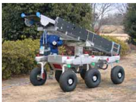
図2 今回開発した親ロボット（伸展式の梯子の上に子ロボットを2台搭載する）
