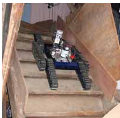
図2 今回開発した親ロボット（伸展式の梯子の上に子ロボットを2台搭載する）
