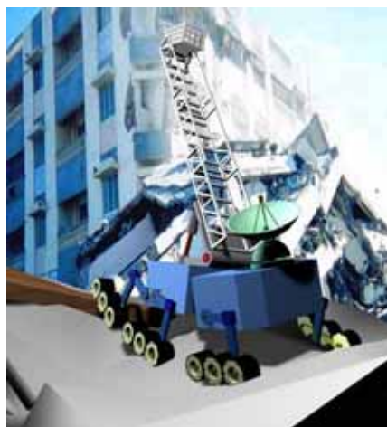
図1 梯子を使った親子型ロボットシステムの基本コンセプト
