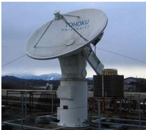
SpriteSat専用 2.4m 衛星追跡用アンテナ
